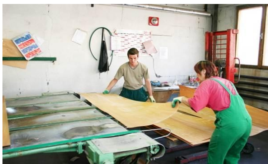
Obrázok 4.6 Ručné triedenie a ukladanie dyhy
