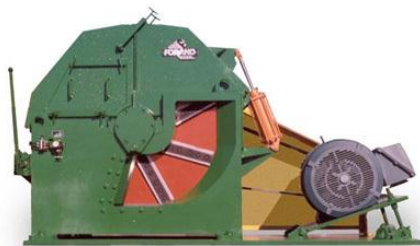
Obrázok 3.2 Princíp sekania dreva na kotúčových sekacích strojoch s vtokovým žľabom
