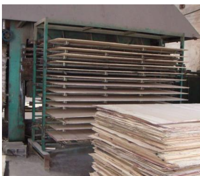
Obrázok 4.12 Mnohoetážový lis na výrobu preglejok (12)
