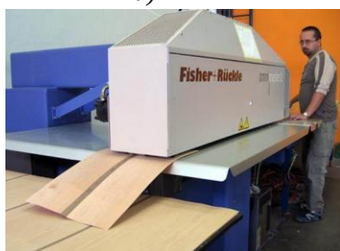
Obrázok 4.9 Zosadzovania dýh (7) a) tavným vláknom ZIG-ZAG, b) lepiacou páskou
