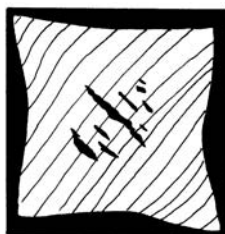
Obrázok 4.5 Deformácia telesa a vznik trhlín pri kolapse (4.2)
