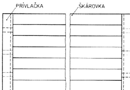
**Obr.8.69: Spevnenie plochy škárovky prívlačkami**
